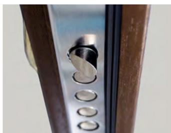
La serratura installata su *Porthos* è del tipo a cassaforte con cilindri in acciaio a più mandate. Per una maggiore sicurezza, la serratura viene installata in una cava all'interno del montante, così da non poter essere manomessa dall'esterno. Inoltre la chiusura è garantita anche dalla presenza di un deviatore superiore ed uno inferiore.
